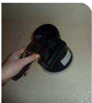
Mesure du débit d'une bouche d'extraction à l'aide d'un anémomètre à hélice avec cône
